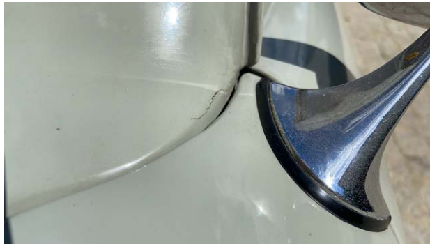
Schadendokumentation: A-Säule Vorne - Links
